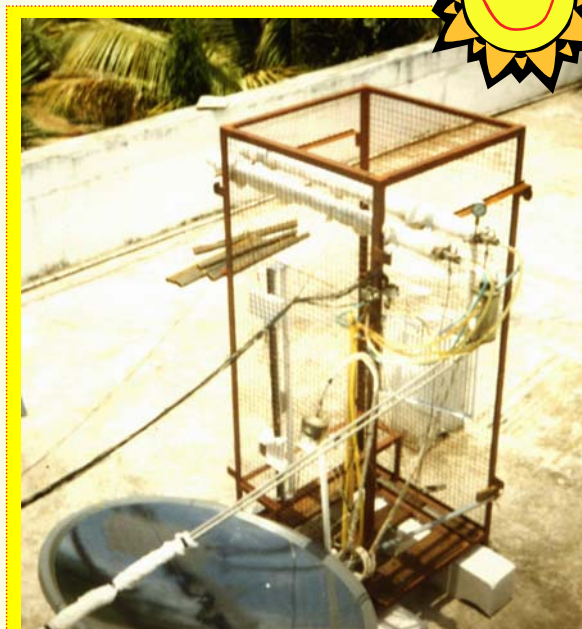
Натурные испытания адсорбционного солнечного холодильника
